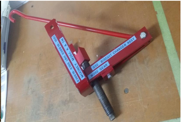
Shock Disc Tool NLG P/N 030010-9100
